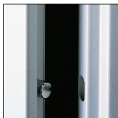
Feuillure des portes à double chicane, pènes inaccessibles par imbrication à la fermeture.
