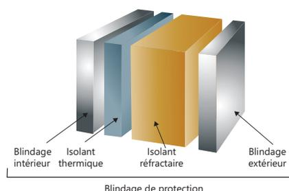
Dans un coffre-fort sans isolant, la température s'élève très rapidement lors d'un incendie. Avec les coffres série MB, vos documents seront mieux protégés. La performance des matériaux ignifuges aux normes DIN 4102 ralentit considérablement la montée de la température interne.
